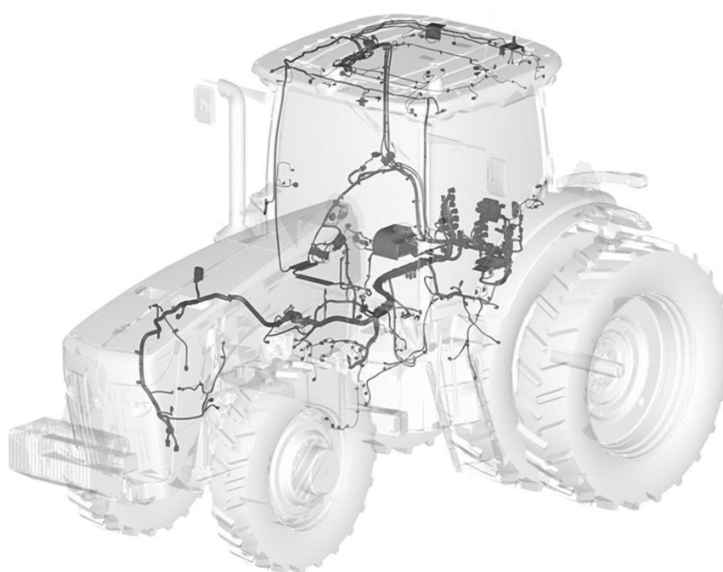
Obr. 10 ukážka rozvetvenia zbernice v traktore (John Deere, 2015)
