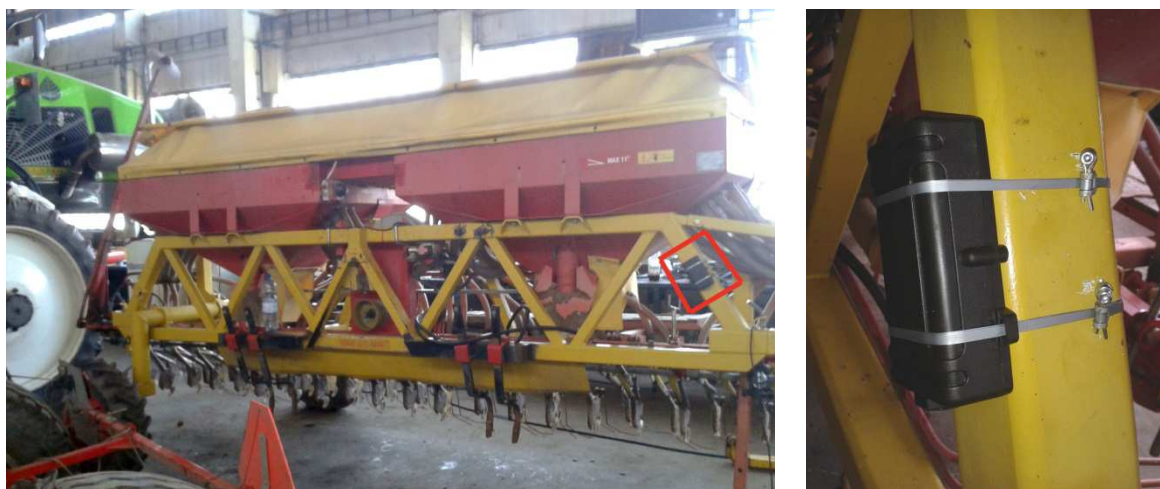
Obr. 24 ukážka inštalácie identifikátora náradia (QADRA, 2015)
