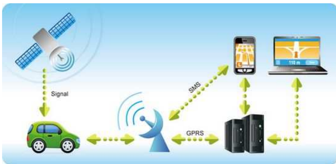
Obr. 3 Princíp monitorovania pohybu vozidiel, alebo strojov (Meitrack Group, 2015)
