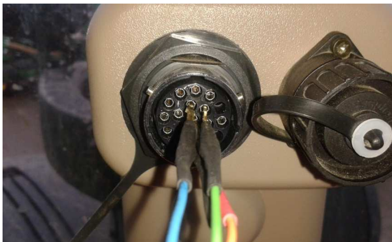
Obr. 12 diagnostická zásuvka v traktore John Deere (QADRA, 2014)
